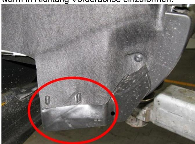
K50) Um eine ausreichende Freigängigkeit der Rad-Reifen-Kombination an Achse 1 zu gewährleisten sind folgende Maßnahmen erforderlich:
